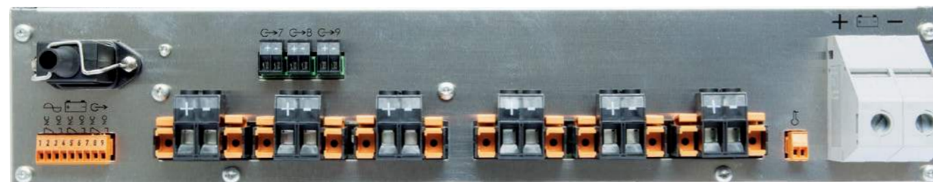
Façade arrière AES 24V/MS 150
